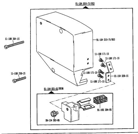
\*) Fadenabschneld-Einrichtung Thread trimmer Coupe-fil Cortahilos
