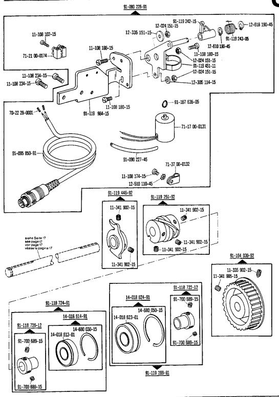
aiehe Erläuterungen Register 0 see explanations in section 0 voir tégende registre 0 ver explicaciones del registro 0 \*) Fadenabschneid-Einrichtung Thread trimmer Coupe-fil Cortahilos 19
