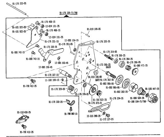
\*) Fadenabschneid-Einrichtung Thread trimmer Coupe-fil Cortabiles
