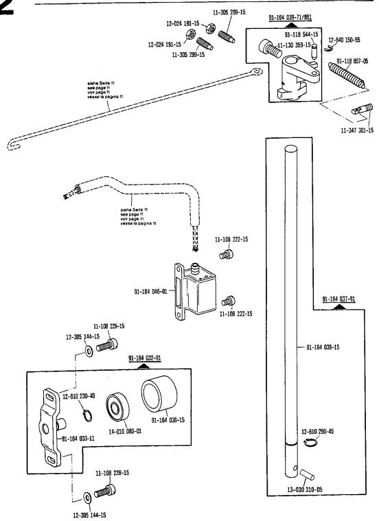
\*) Fadenabschneid-Einrichtung Thread trimmer Coupe-fil Cortahilos
